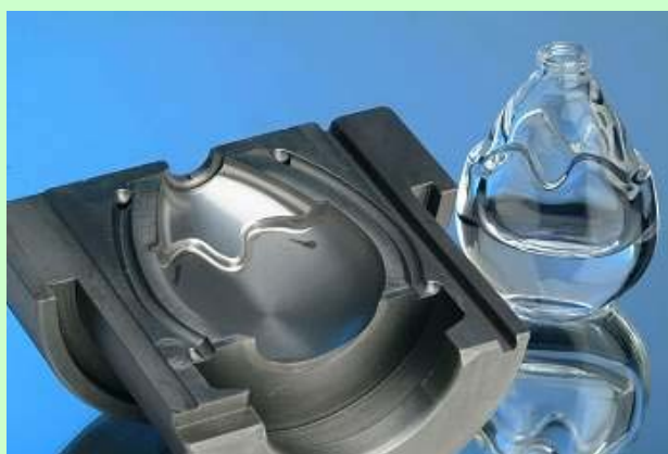
Molde metálico para a fabricação de peças de vidro: a parte inferior do molde foi deixada sem polimento, enquanto a parte superior foi polida com a nova técnica de polimento a laser. [Imagem: Fraunhofer ILT]
